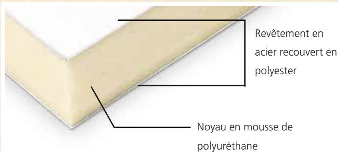
L'assemblage final résulte de la pression qu'exercent les plaques en acier sur la mousse.
