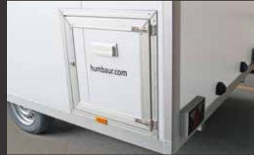
Armoire de bouteilles à gaz accessible de l'extérieur
